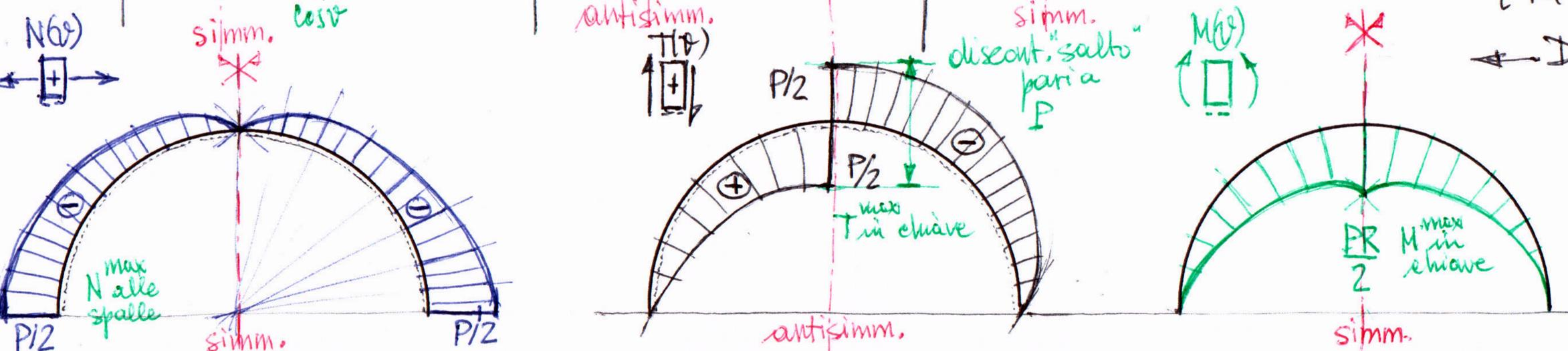
DIAGRAMMI  $N, T, M$  (disegnati sulla struttura stessa): curvatura dell'andamento funzionale sommate alle curvatura delle linee d'asse
