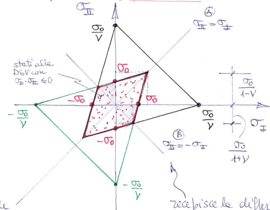
• 3) Criterio di Beltrami (per materiali a comp. simmetrico<sup>1</sup>) a trazione-compressione
