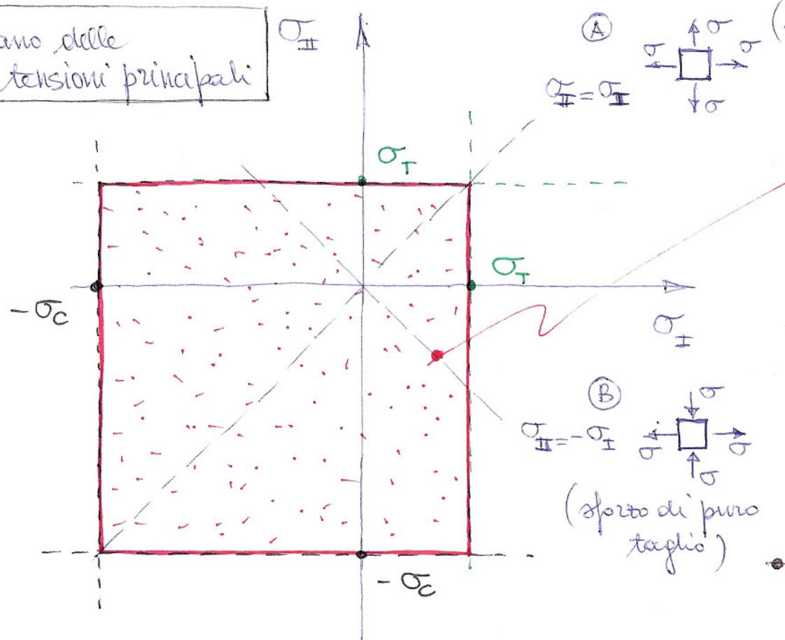
(Sforzo idrostatico nel piano)
