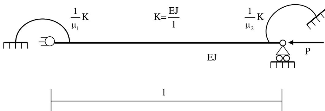
I parametri positivi  $\mu_1$  e  $\mu_2$  descrivono le rigidezze elastiche delle molle rotazionali d'estremità.
