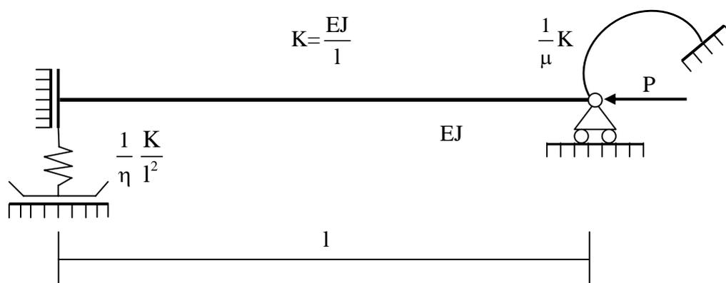
I parametri positivi  $\eta$  e  $\mu$  descrivono rispettivamente le rigidezze elastiche delle molle d'estremità, traslazionale a sinistra e rotazionale a destra.
